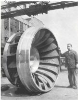
FON: ruota in bronzo del peso di 50 tonnellate per turbina « Francis » fornita alla « Sot. Costruzioni Meccaniche Alfa » di Milano.
