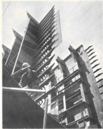
Sotto di lavoro al Cantiere di Sestri. Sopra a sinistra: blocco di prua prefabbricato della turbomarina «British Signet» di 26.380 t.d.w. in procinto di essere trasportato a bordo. Sopra a destra: particolare di una turbomarina di 32.380 t.d.w. in costruzione. Sotto: imbarco di una turbina per la «Leonardo da Vinci».
